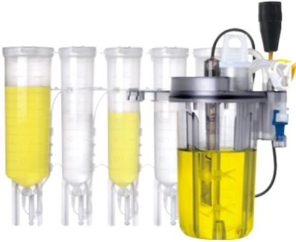
Ambr<sup>®</sup> 250 Modular 是一种高性能的创新型台式生物反应器系统，可集成多个 100 - 250mL 一次性容器。该系统采用了最初 ambr<sup>®</sup>250 高通量系统中率先使用的先进搅拌罐生物反应器技术。
